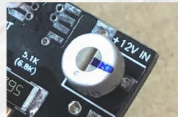
Рис. 7 Пример расположения подстроечного резистора.
