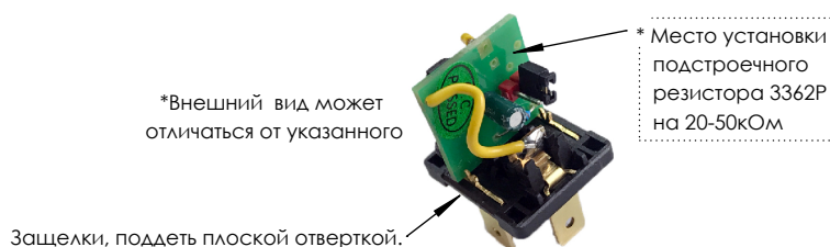
Рис. 2 Реле со снятой крышкой.
