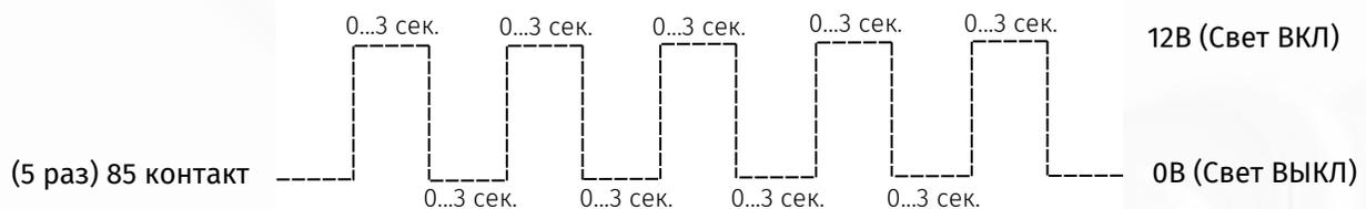
Рис. 3 Вход в режим настройки яркости.
