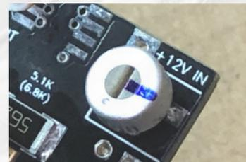
Рис. 7 Пример расположения подстроечного резистора.
