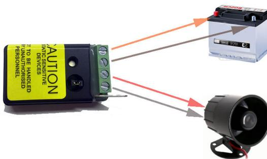
В таком варианте датчик будет каждый раз при малейшем наклоне выдавать кратковременные сигналы (пик-пик-пик) в случае наклона автомобиля. Это бывает особенно полезно когда установленная сигнализация в машине не всегда фиксирует удары, например в случае ДТП, работы эвакуатора, или не дай бог при снятии колес с транспортного средства.
