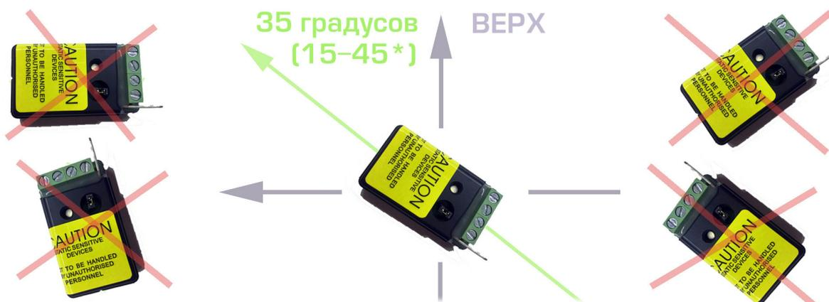
В случае, если датчик закреплен не правильно, светодиодный индикатор будет мигать (перемигивать зеленым или красным цветом). Правильно установленный датчик в правильном направлении в спокойном состоянии (если не менять положение и угол датчика) не будет мигать индикатором, это и будет означать правильность установки.
