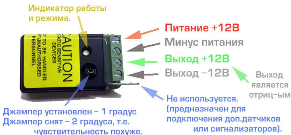
В качестве выхода можно использовать клаксон (сирену) от автомобильной сигнализации, при подключении клаксона следует соблюдать полярность.
